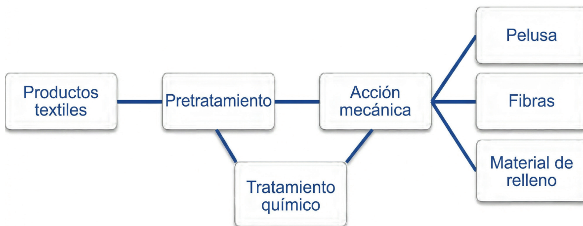
Figura 3.1. Pasos genéricos para el reciclaje mecánico. (Fuente: Duhoux et al., 2021)
